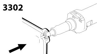
اجازه دهید که دستگاه حداقل یک دقیقه بدون بار کار کند تا از مونتاژ درست آن اطمینان حاصل نمایید. اگر سنگ انگشتی لنگ می‌زد و یا لرزش داشت فوراً آن را تعویض نمایید.
